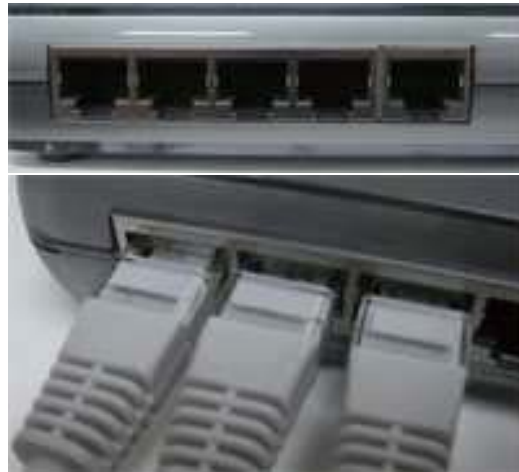
그림 1.11: LAN선을 이용한 공유기 연결
