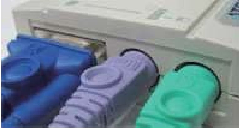
그림 1.7: 연결 방법 : 좌측부터 모니터, 키보드, 마우스를 콘솔 포트 커넥터로 연결
