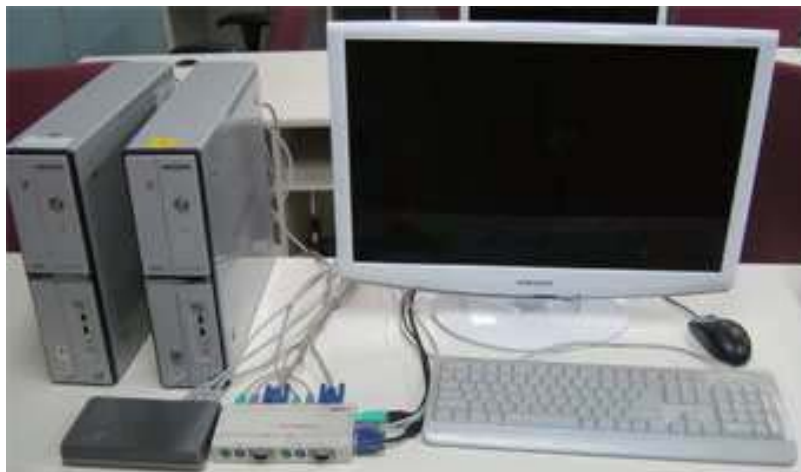
그림 1.12: 클러스터 장치 연결이 완성된 모습
